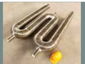
ساخت Radiant Tubes
