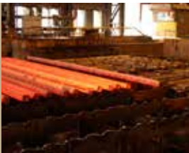
ساخت بستر خنک کننده بیلت
