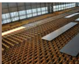
ساخت بستر خنک کننده ورق گرم نور دیده
